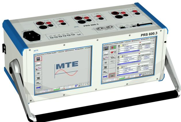
Der Prüfzähler des modularen Systems basiert auf der erprobten digitalen Messerfassung, schneller Analog-Digitalkonvertierung und Berechnung der Werte mit Hilfe schneller Signalprozessoren. Heute werden Prüfzähler, im Gegensatz zu früher, nicht nur als stationäre Normale für die Zählerprüfung in einer Prüfeinrichtung, sondern zunehmend auch im Feld zur Messung der gesamten Netzparameter eingesetzt.
